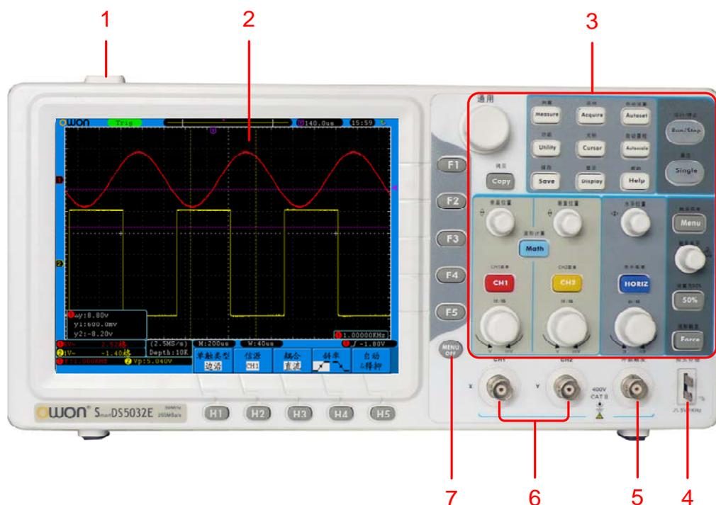
图4-1 SDS5032E(V)示波器前面板
