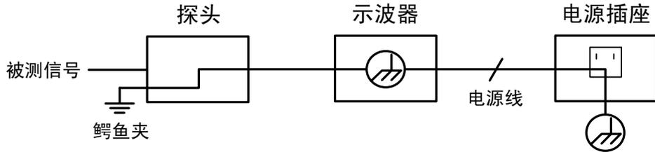
示波器（电池供电）通过端口与计算机（交流供电）连接时的内部地线连接示意图：
