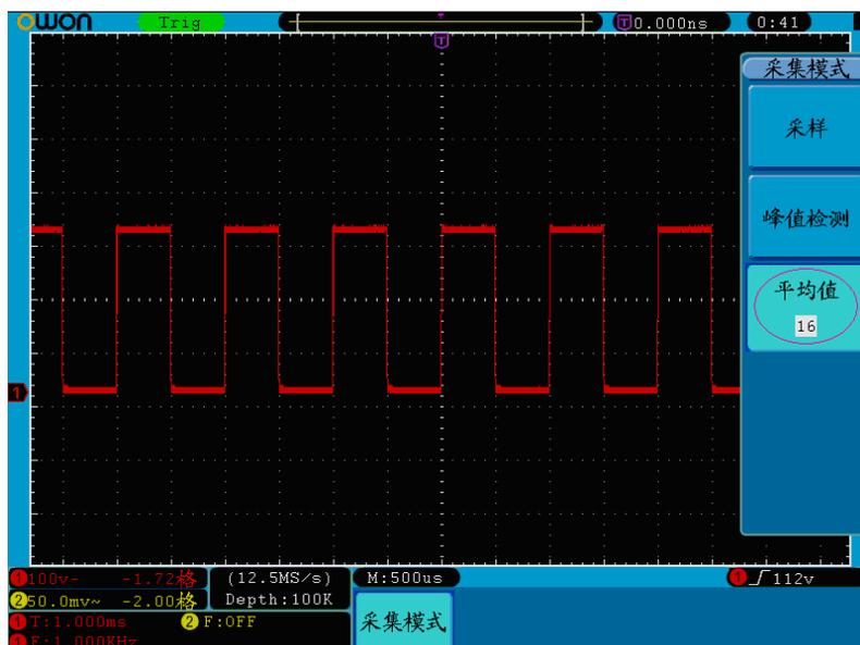
图 5-28 平均次数为16次平均值方式，去除噪声后的显示波形
