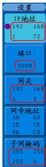
图5-52 设置示波器的网络参数
