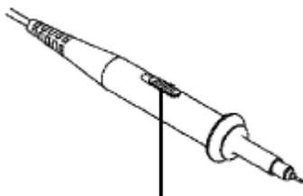
图 4-9: 探头衰减开关
