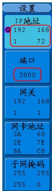
图5-49 设置示波器的网络参数
