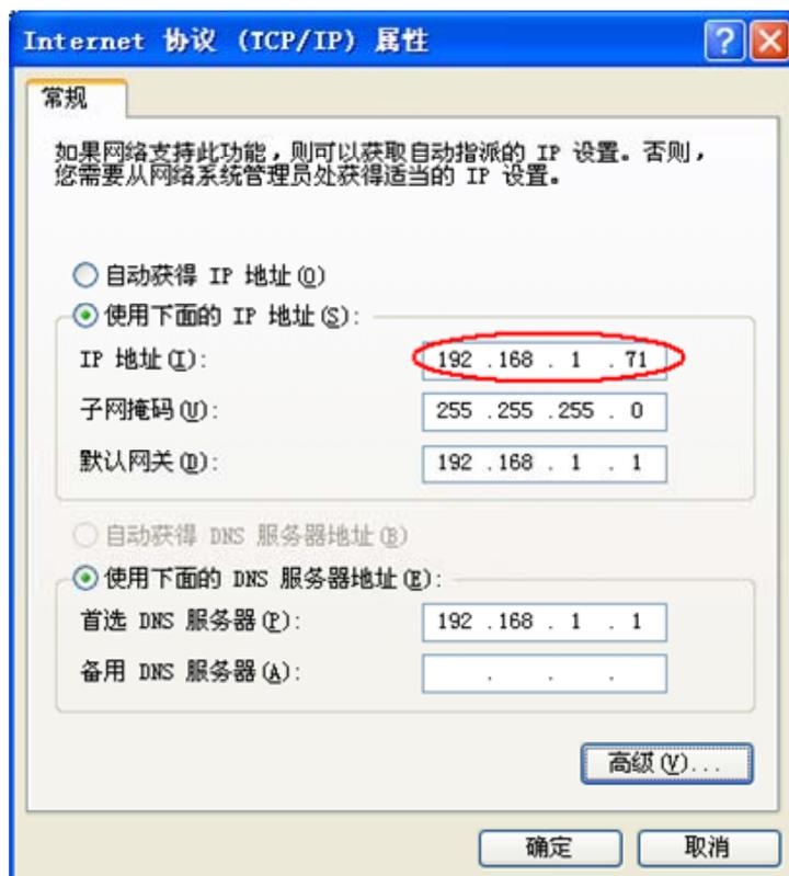
图5-47 设置计算机的网络参数
