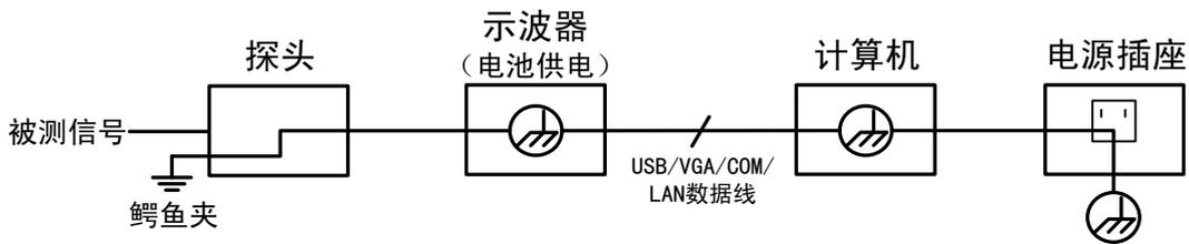
在示波器交流供电，或者电池供电的示波器通过端口与交流供电的计算机连接的情况下，不可以测量电网一次侧电源。
