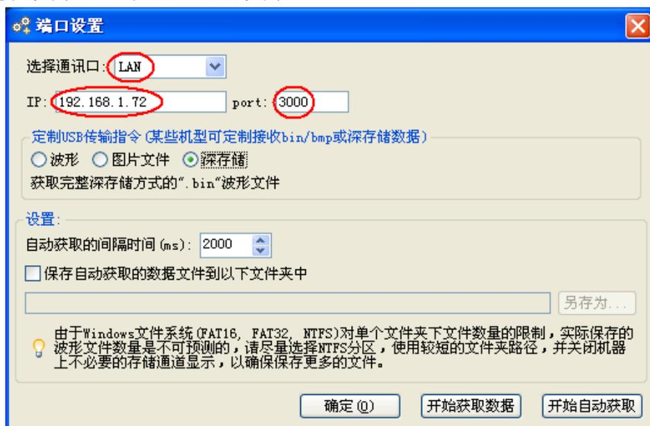
图5-51 设置上位机的网络参数
