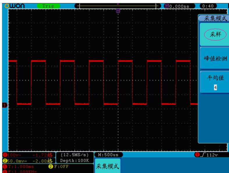
图 5-27: 普通采样方式显示, 检测不到毛刺。
