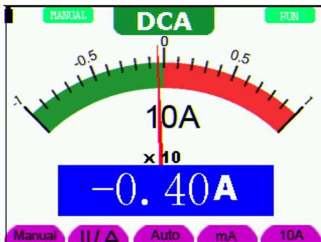
图 28: 直流电流10A量程测量界面
