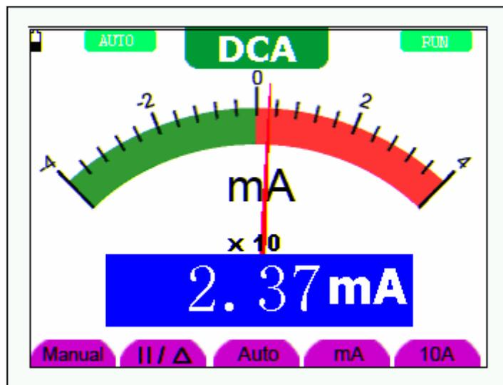
图 27：直流电流测量界面
