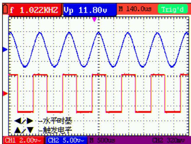
图 7: 水平时基、触发电平显示界面
