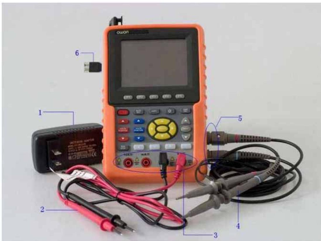
图2：示波表的连接
