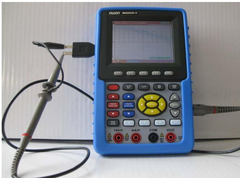
图 3 方波测试信号连接
