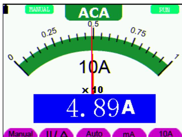
图 30：交流电流10A测量界面
