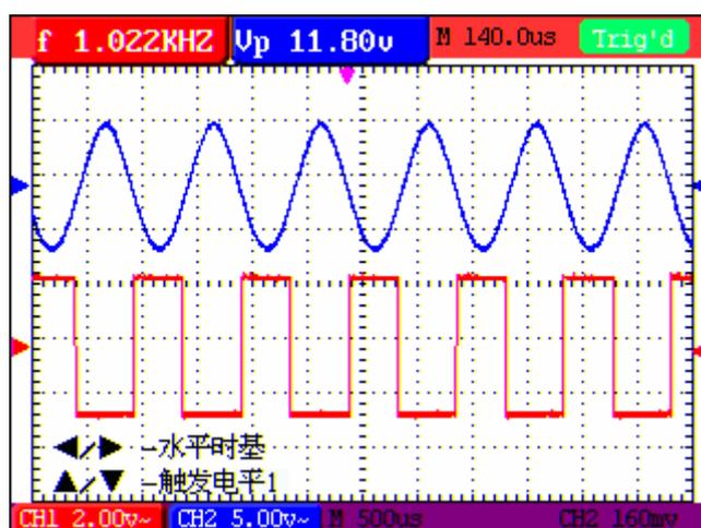
图 10 : 水平时基、触发电平 1 显示介面
