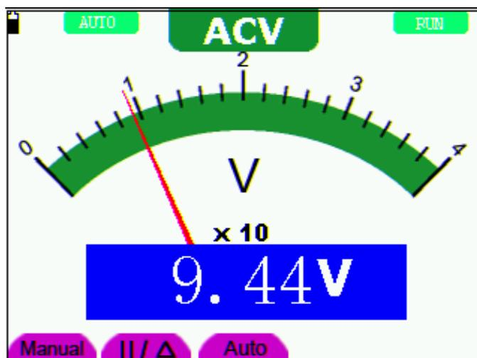
图 26: 交流电压测量界面
