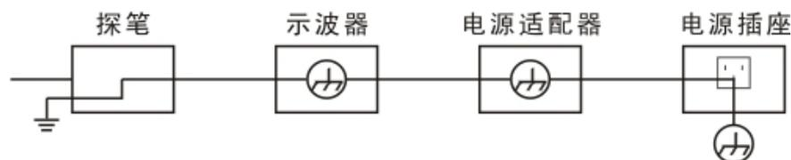
在适配器插着电源给示波器充电的情况下，不可以测量电网一次侧电源。
