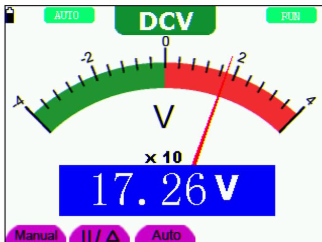
图 25: 直流电压测量界面
