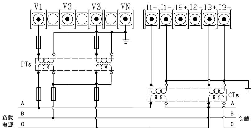
2-3. 三相三线系统，采用无 PT，2CT 方式的接线图（适用于 3P3L，见 6.3.2 的设置仪表参数）
