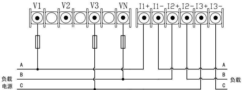
3-2. 三相三线系统, 采用 3CT, 2PT 方式的接线图 (适用于 3V3A, 见 6.3.2 的设置仪表参数)
