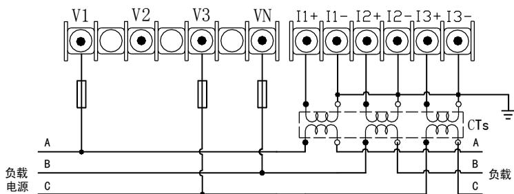
4-1. 三相四线系统，采用无 CT，无 PT 连接方式的接线图（适用于 3P4L，见 6.3.2 的设置仪表参数）
