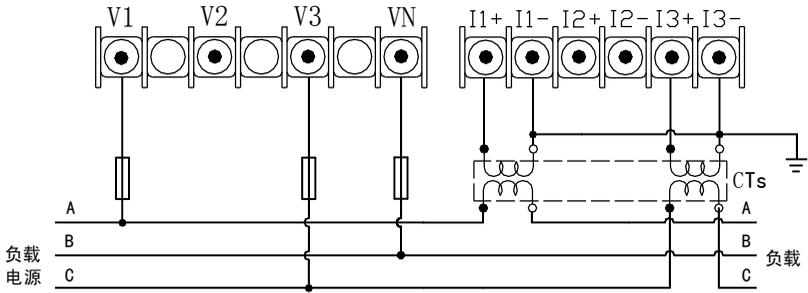
3-1. 三相三线系统, 采用无 CT, 无 PT 连接方式的接线图 (适用于 3V3A , 见 6.3.2 的设置仪表参数)
