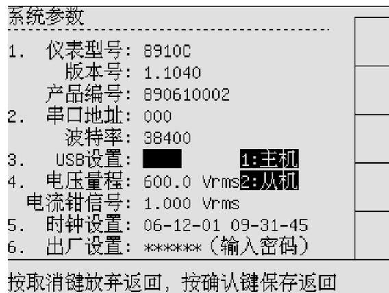
图 3-4 SYSTEM 设置—USB 设置
