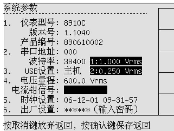
图 3-5 SYSTEM 设置—电流钳信号
