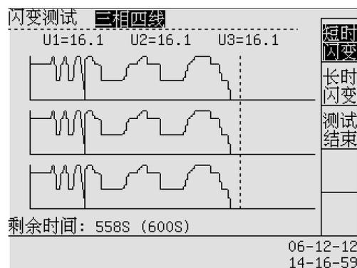
图 12-2 闪变测试屏幕——短时闪变
