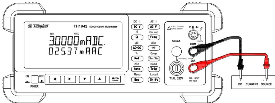
在 5A, 20A 量程的直流连接方式
