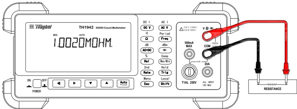
注意：电流源流经  $V\Omega$ ，DUT，COM 端。
