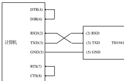
图 5-1 RS-232 连接示意图
