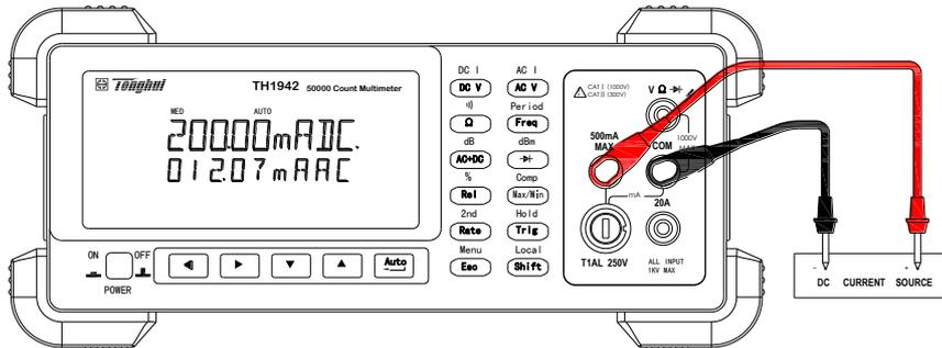
在 5mA, 50mA, 500mA 量程的直流连接方式
