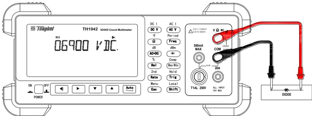
注意：电流源流经 **VΩ**、DUT、**COM** 端。
